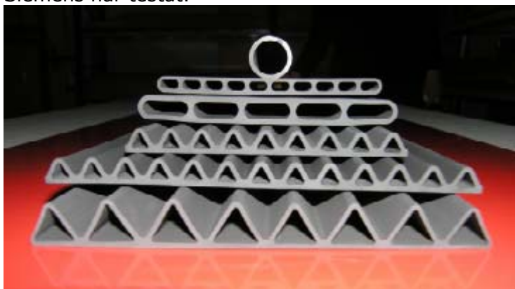
Olika profiler av SOFC celler framtagna av Siemens, cirkulära, HPD och delta celler
